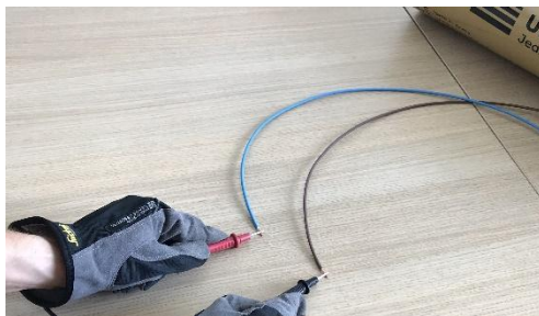
Kontrola a zaznamenání el. odporu do Záručního listu
